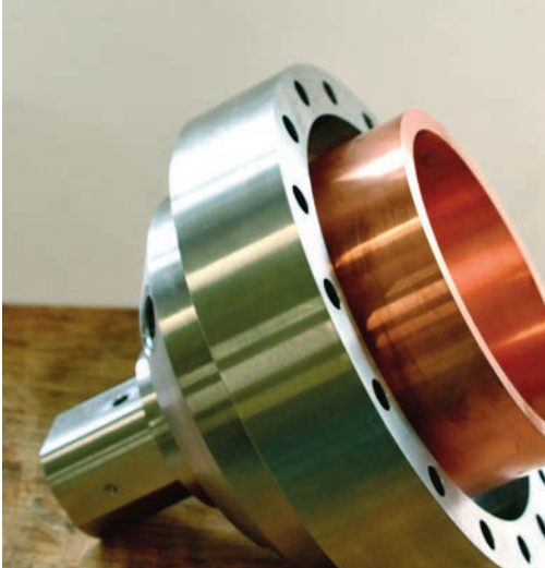
ABB. 1-3 Komponenten eines 2000 Newton Hybrid Triebwerks, das im Rahmen des DLR STERN Programms entwickelt wurde.
