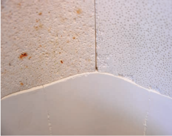
ABB. 1 Eine dichte, schallreflektierende Hitzeschutzkachel (unten) und schalldämmende Keramiken oben. Links durch vulkanisches Perlit und rechts durch Styropor als Platzhalter hochporös gemacht.
