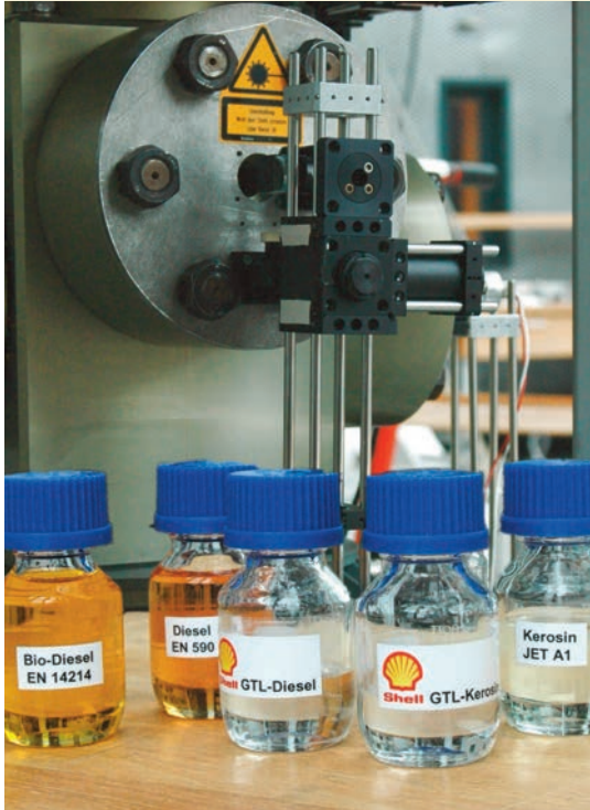
ABB. 2 Neben der vergleichenden Untersuchung technischer Kraftstoffe werden Modellbrennstoffe für die Zünd- und Verbrennungssimulation experimentell bestimmt.
