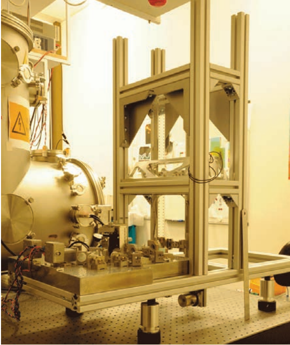
ABB. 1 Mikro-Newton Schubmesswaage: Im Vordergrund ist das Laser-Interferometer zu erkennen vor den langen Pendeln. Auf der linken Seite im Bildhintergrund steht die Vakuumkammer, in die der Teststand eingebracht wird, um die Messung durchzuführen.
