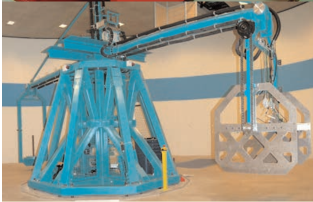
ABB. 1 UND 2 Der Vibrationsstand und die 30 g Zentrifuge ergänzen als wichtige Qualifikations- und Materialprüfungsanlagen die Laboreinrichtungen des ZARM
